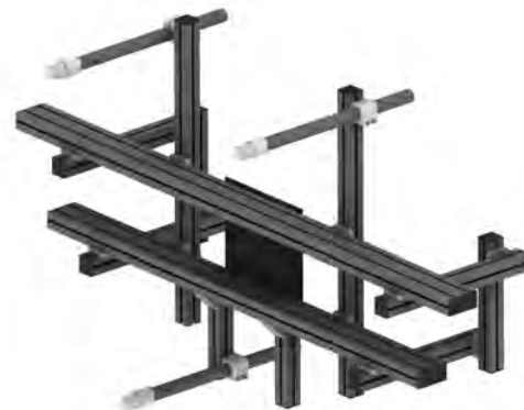
Grundrahmen für Stoßfängergreifer „Matritzenentnahme“
