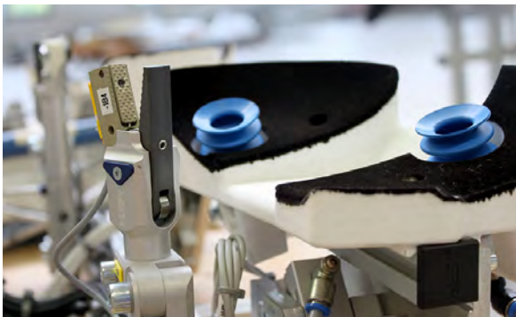
Beflocktes Konturstück zur besonders schonenden Materialentnahme für empfindliche Produkte
