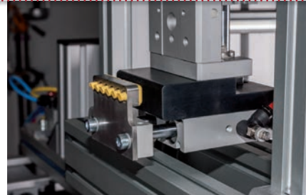
Kombination aus Führungsschlitten und Doppelkolbenzylinder
