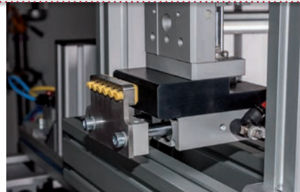
Kombination aus Doppelkolbenzylinder und Führungsschlitzen
