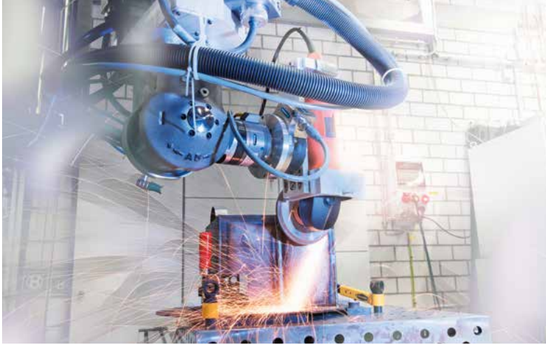
Automatisiertes Schleifen von Zuluftkammern für Kaminöfen
