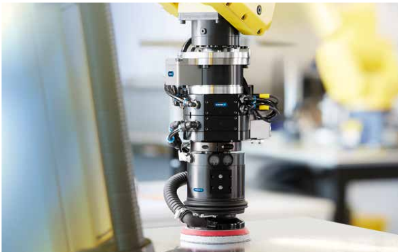
Automatisiertes Schleifen mit dem Roboter
